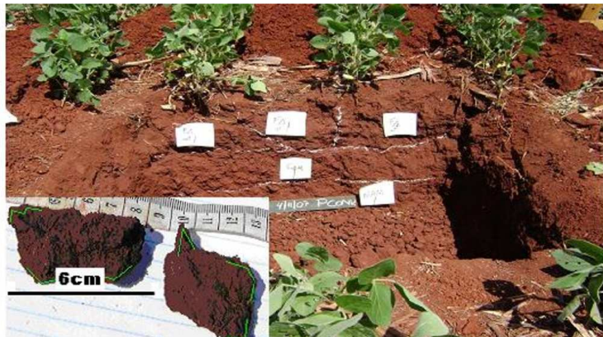
Figura 19 - Estruturas angulares – produto de destorroamento mecânico de adensamento/compactação ao longo do perfil do solo sob plantio convencional
