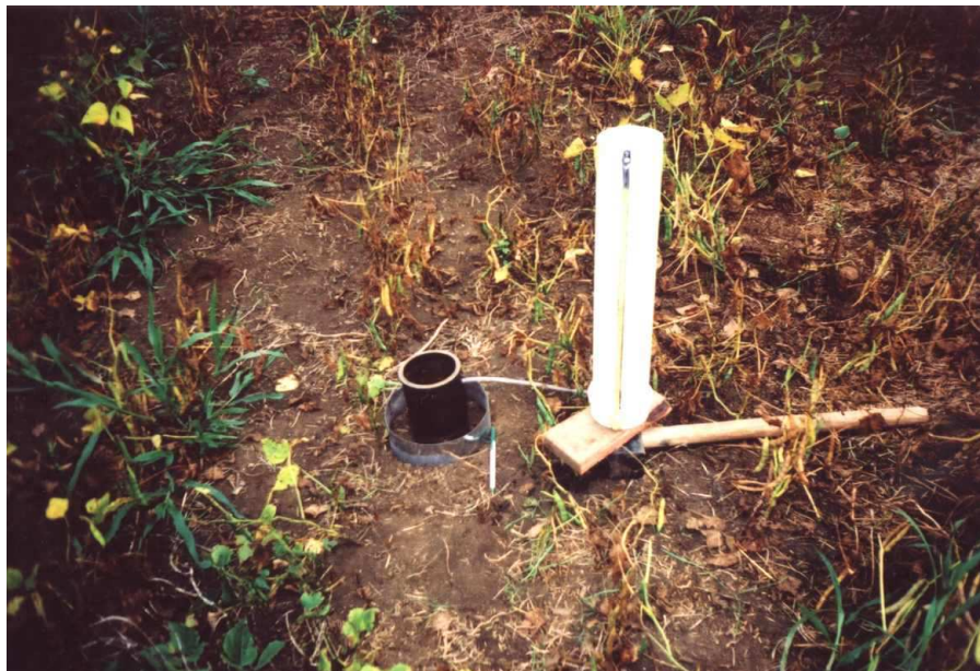
Figura 4: Ensaio de capacidade de infiltração, segundo método do infiltrômetro. Foto: Nelson Douhi - 2003
