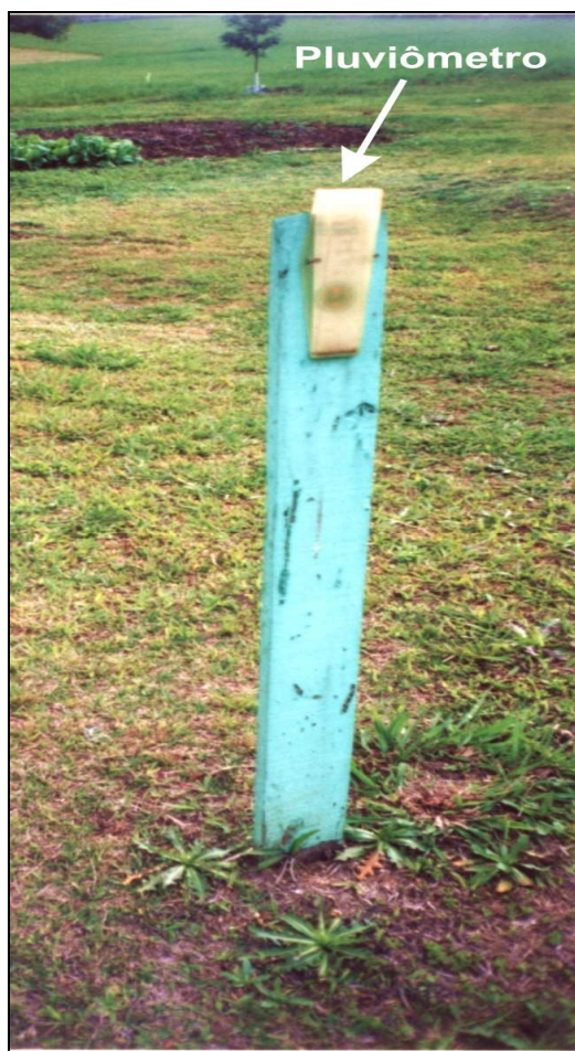
Figura 5: Pluviômetro de leitura direta, instalado segundo metodologia de Pinto et al. (1973), localizado na Cooperativa Agrícola Mista de Prudentópolis. Foto: Nelson Douhi – 2003
