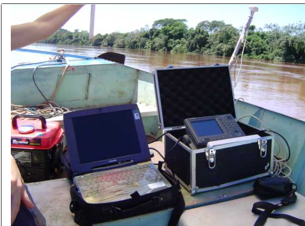
Figura 6: Ecossonda e GPS acoplada a um computador portátil.
