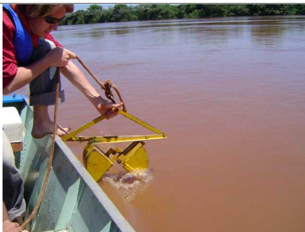
Figura 8: Amostrador de fundo tipo Van Veen.
