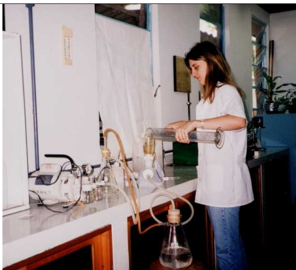
Figura 10: Material coletado sendo filtrado à vácuo.
