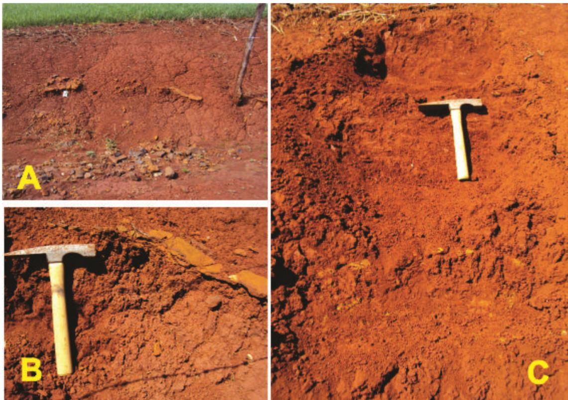
Figura 54: A) Perfil de solo bruto; B) Camada de concreção ferruginosa; C) Perfil de solo com presença de concreções ferruginosas
