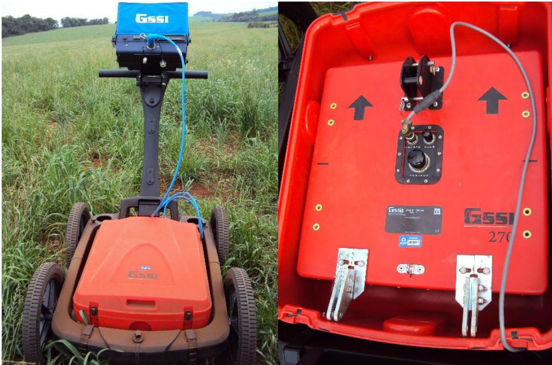
Figuras 3 e 4: Aparelho GPR e antena de 270MHz da marca GSSI
