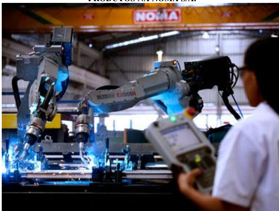
FIGURA 26: ROBÔ DE SOLDA MIG UNE COMPONENTES DE UMA NOVA LINHA DE PRODUTOS NA NOMA S/A.
