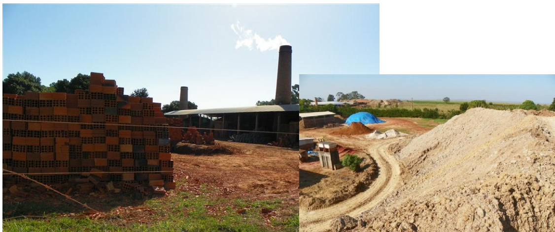
Foto 37. Olaria em Paranapoema. No município, funcionam algumas olarias que a partir da matéria prima de fácil acesso produzem, tijolos, lajotas, telhas etc. (Rigon, 2011).
