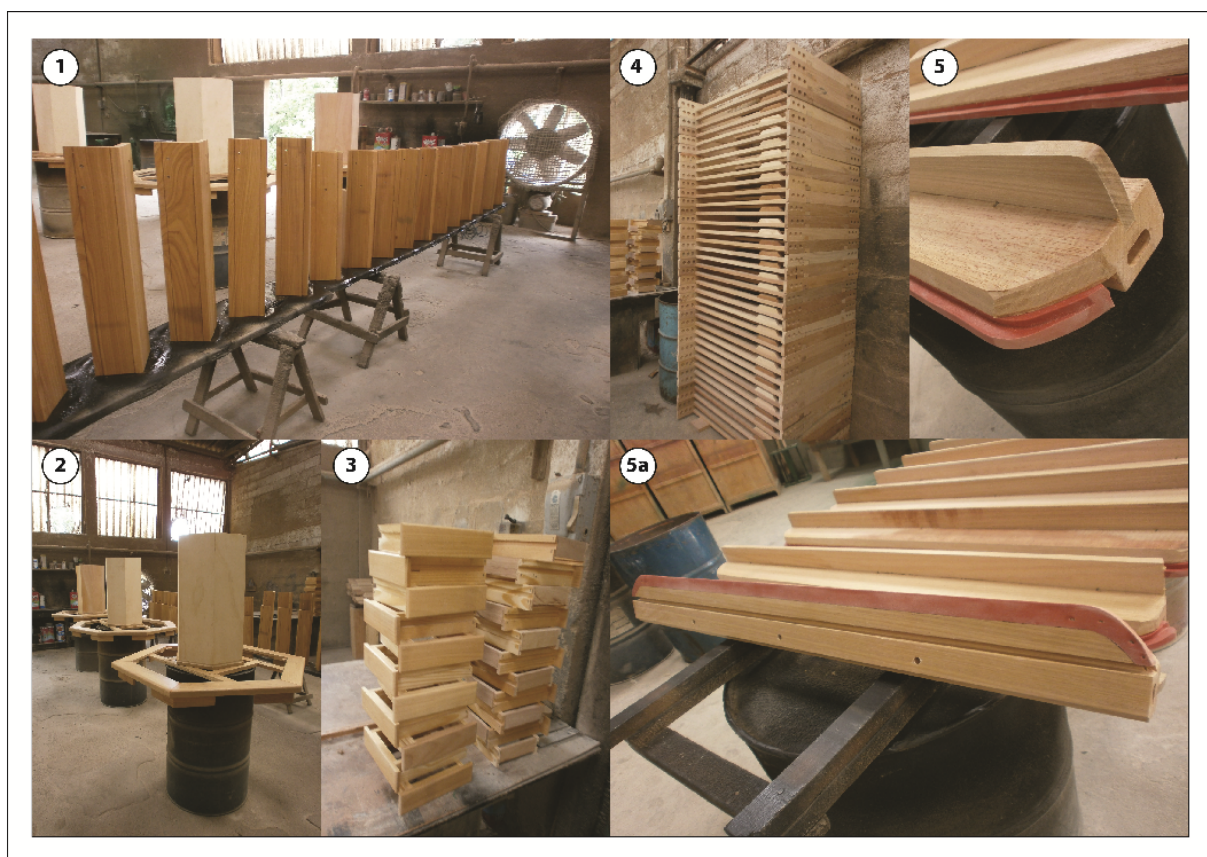
Figura 23: Visão parcial do Setor de verniz. No detalhe, em processo de secamento, os pés da mesa na foto 1 após a aplicação do verniz. Na foto 2 tem-se os pés e tampos de mesas para carteadado e as gavetas para ficheiro na foto 3. Pode-se observar também a taqueira na foto 4 e a tabela em detalhe nas fotos 5 e 5a.
