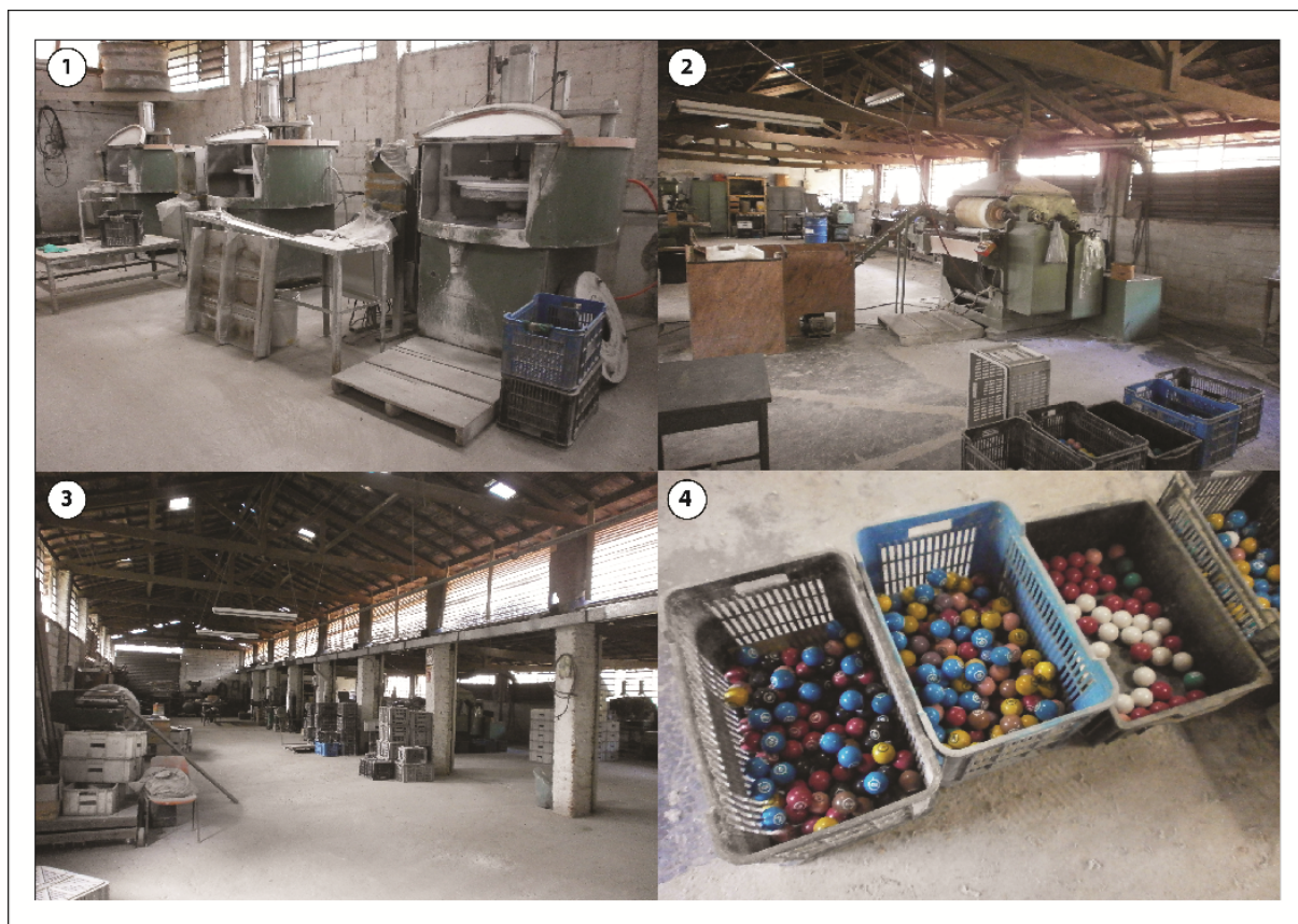
Figura 27: Setor de fabricação de equipamentos e máquinas adaptadas / Finalização das bolas. Neste setor encontram-se máquinas como a lixadeira (foto 1) e a polidora (foto 2) de bolas. Por meio da foto 3 tem-se uma na visão parcial deste setor. Nesta área foram criadas/adaptadas as máquinas e equipamentos utilizados por Antonio Hernandez junto aos seus empregados e colaboradores. O produto acabado (bola) pode ser visualizado na foto 4
