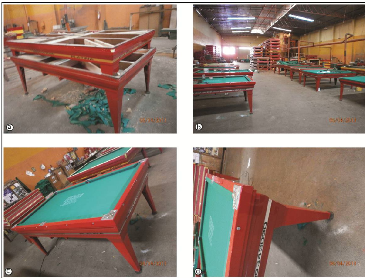
Figura 11: Mesas para bilhar em aço fabricadas pela Platina Bilhares. Na foto a pode-se observar o interior da mesa em madeira; nas fotos b , c , d tem-se a vista parcial da estrutura externa em aço. Fonte: Levantamentos de campo, abril de 2013. Org.: VEIGA, L. A, 2013.
