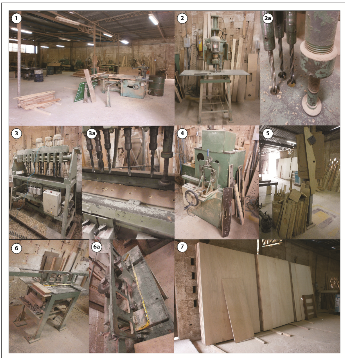
Figura 24: Visão parcial do Setor de recebimento e corte da madeira. Neste a madeira bruta fica acondicionada (foto 1) para ser trabalhado posteriormente por máquinas como a que realiza furos no painel que fará parte da base da mesa (fotos 2 e 2a). Na foto 3 e 3a observa-se uma máquina que perfura simultaneamente diversos orifícios no painel lateral das mesas de pebolim. Na foto 4 tem-se uma máquina adaptada que faz o corte da lateral do painel onde é instalada a gaveta de fichas ou somente para efeito decorativo. Nas fotos 5 e 7 observa-se a disposição da matéria-prima que posteriormente irá compor as peças da mesa para bilhar. Por fim nas fotos 6 e 6a tem-se uma máquina também adaptada para o corte otimizado de algumas peças de madeira.
