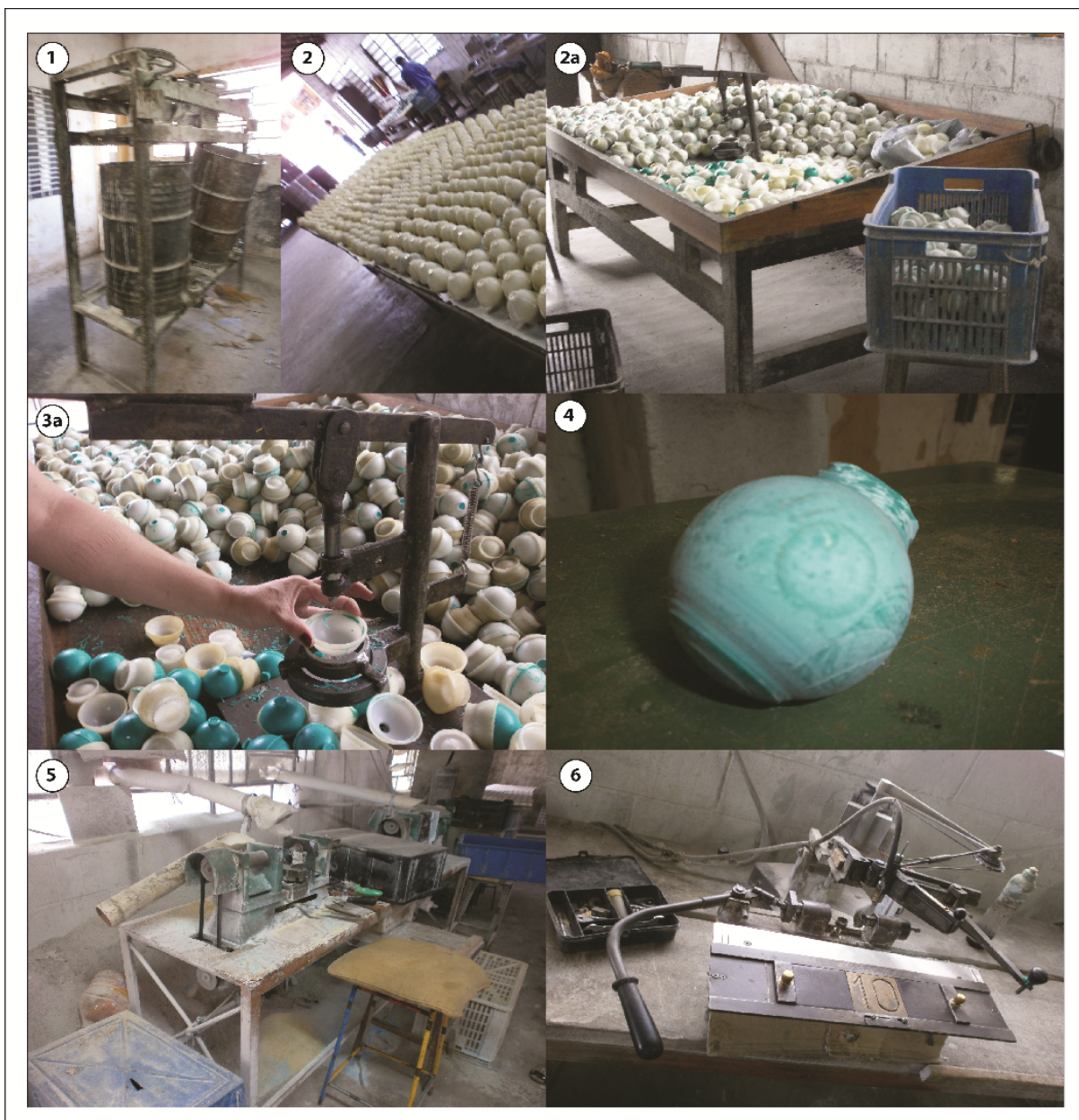
Figura 26: Galpão em que são fabricadas as bolas. Na foto 1 os latões estão cheios de resina de poliéster líquida que é acondicionada em esferas ocas - moldes conforme as fotos 2 e 2a. Estas esferas permitirão a secagem do líquido e darão a forma característica do item. Para retirar as bolas dos moldes foi criado o equipamento da foto 3a. Como se verifica na foto 4, devido às rebarbas presentes na bola retirada dos moldes, a mesma passa por uma máquina adaptada (foto 5) que lixa as imperfeições para depois deixar a bola preparada para o recebimento do número, realizado em um equipamento adaptado de serigrafia, conforme foto 6.
