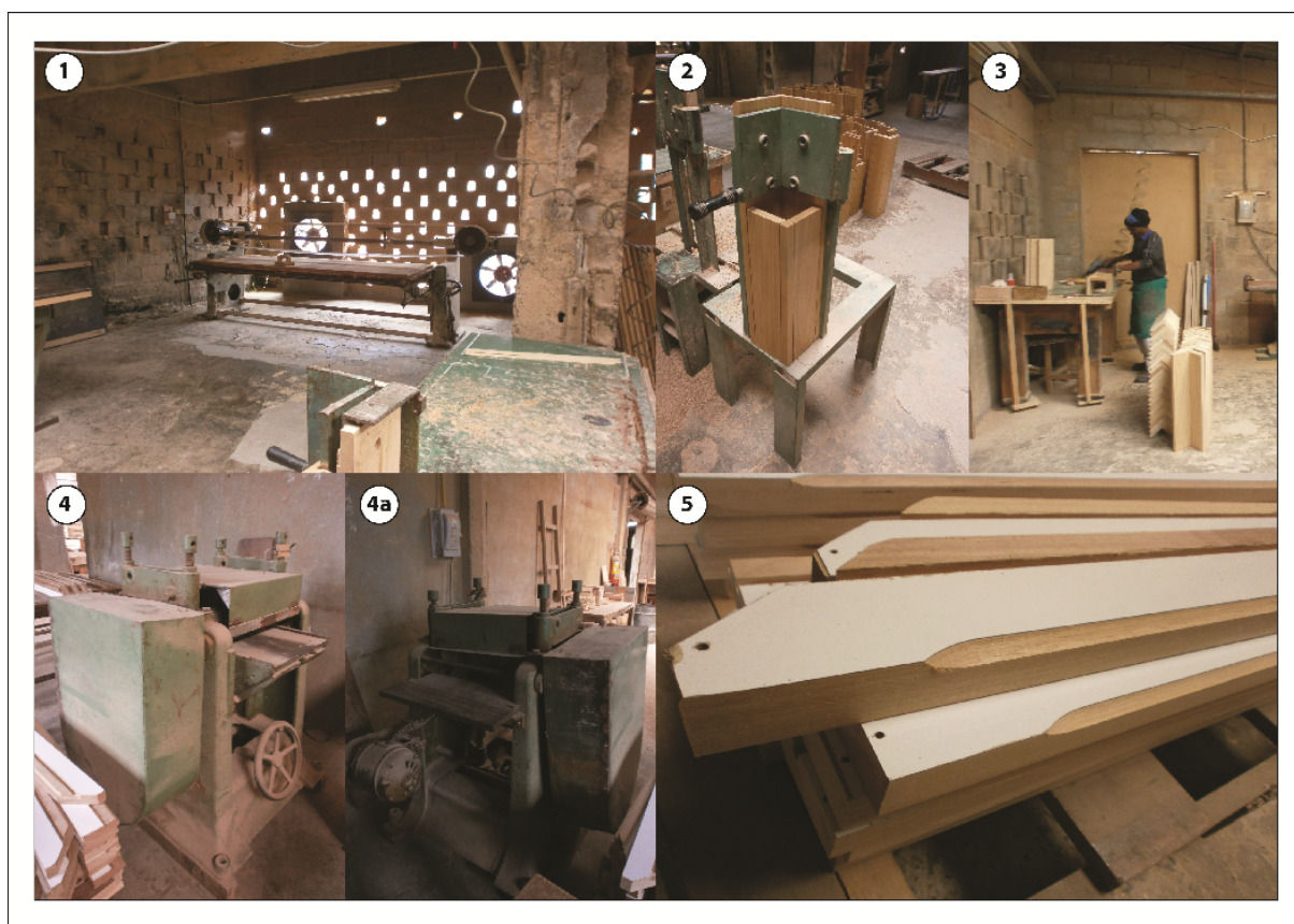
Figura 22: Visão parcial do Setor de fabricação dos pés e polimento de peças da mesa. Na foto 1 observa-se uma máquina de lixar e ao fundo chama-se a atenção para a furação nas paredes e aos dois exaustores que retiram o pó do ambiente. Na foto 2 tem-se um equipamento criado pelo empresário para auxiliar na furação dos pés da mesa, funciona como um gabarito de furação. Na foto 3 observa-se um funcionário trabalhando algumas peças. Na foto 4 tem-se uma máquina adaptada para o prensamento da tabela junto à fôrmica (foto 5), peças denominadas tabela. Foto: VEIGA, L. A., 2013. Fonte: Levantamentos de campo, 2013.
