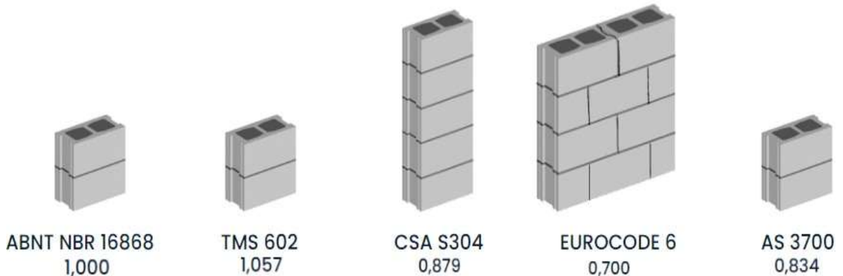
Figura 4.25 – Fator de correção para prismas com 2 blocos ( h=390\text{mm} e t=190\text{mm} )
