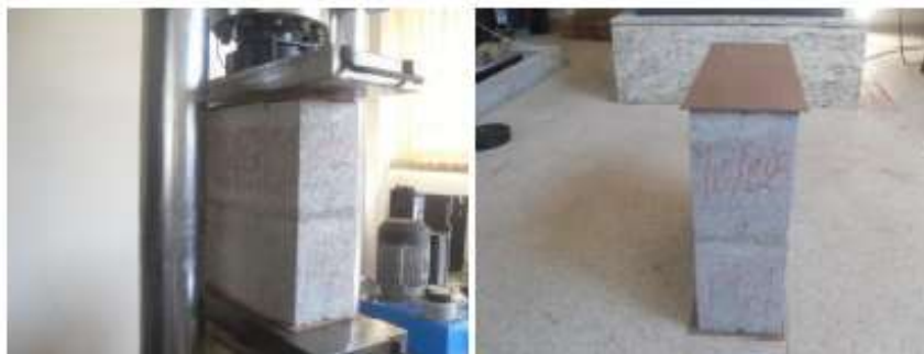
Figura 2.4 - Ensaio de prisma e capeamento do prisma
