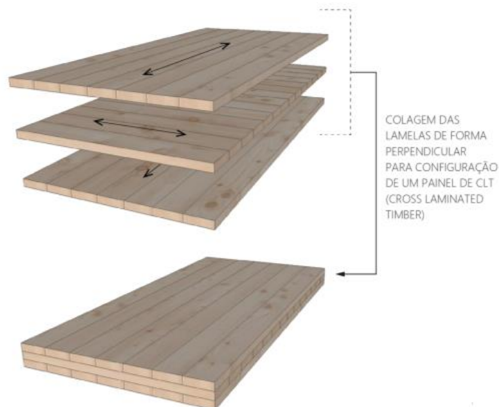
Figura 1.2 - Configuração de elementos construtivos em CLT
