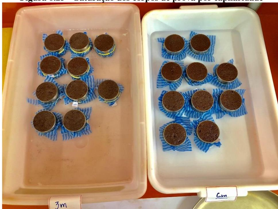
Partindo-se da saturação total, foram estabelecidos valores de umidade de secagem para a obtenção dos pontos intermediários da curva característica, até a umidade residual. A escolha da umidade de cada corpo de prova, correspondendo a um ponto da curva, foi realizado por meio do controle de sua massa úmida, considerando-se que a massa dos grãos não varia ( $M=M_s(1+w)$ ). Sendo assim, qualquer alteração ocorrida na massa do solo é proveniente da perda ou ganho de água.
