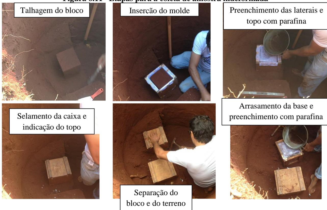
A base da caixa foi devidamente selada e parafusada, e no topo da amostra foi inserida uma nova etiqueta de identificação (Figura 6.12a). A coleta de amostras deformadas foi realizada por meio de vangas, sendo identificadas e devidamente acondicionadas em sacos plásticos até serem levadas ao laboratório, no menor tempo possível (Figura 6.12b).
