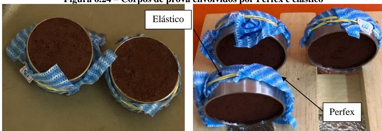
**Figura 6.25 – Saturação dos corpos de prova por capilaridade**
