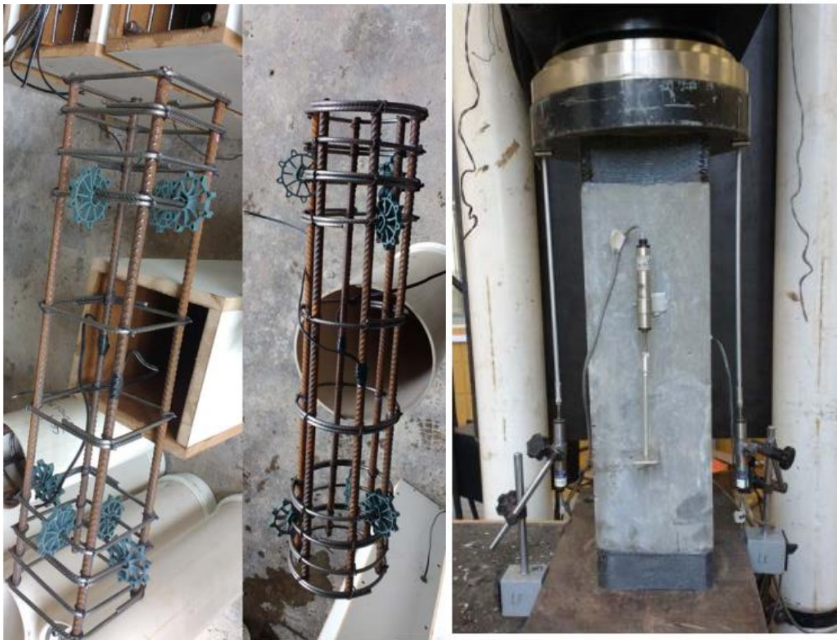
Figura 2.21 – Instrumentação das armaduras e metodologia de ensaio
