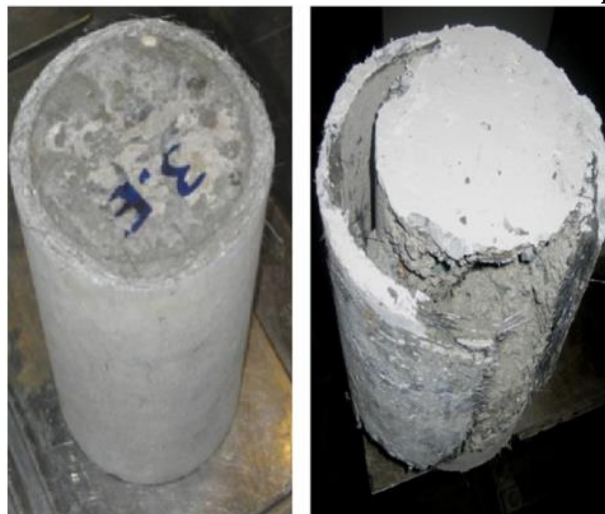
Figura 2.25 – Amostras de concreto confinado antes e depois do ensaio
