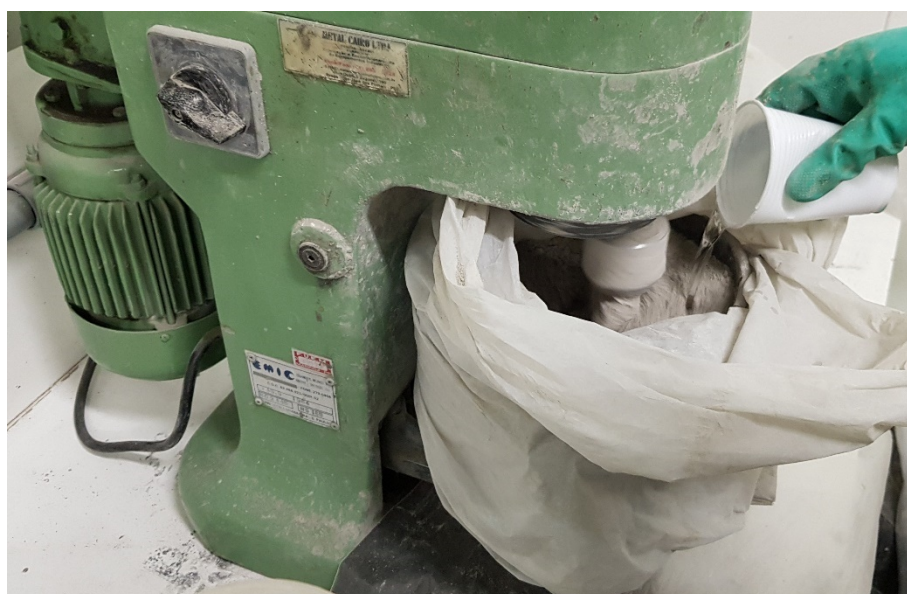
Figura 3.10 – Adição de água a mistura de UHPC
