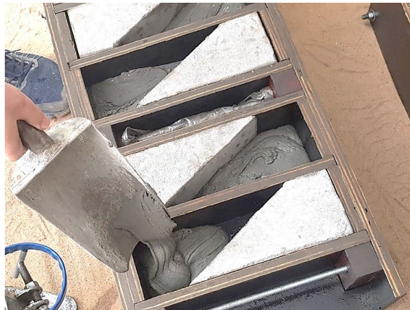
(b) Concretagem dos reparos (nesta foto, UHPC)
