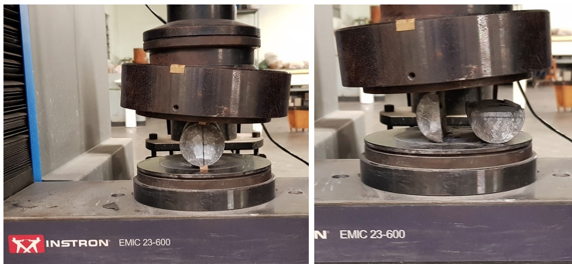
Figura 4.6 – Ensaio de resistência à tração por compressão diametral em UHPC
