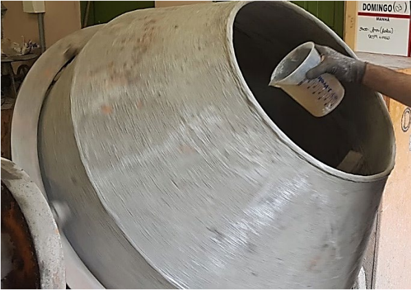
(e) Etapa 3: Mistura com o aditivo superplastificante com duração de aproximadamente 2 minutos
