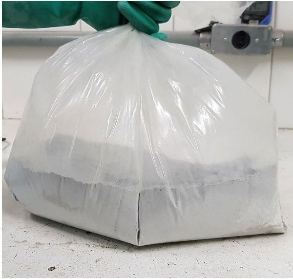
Figura 3.7 – Mistura manual dos materiais secos
