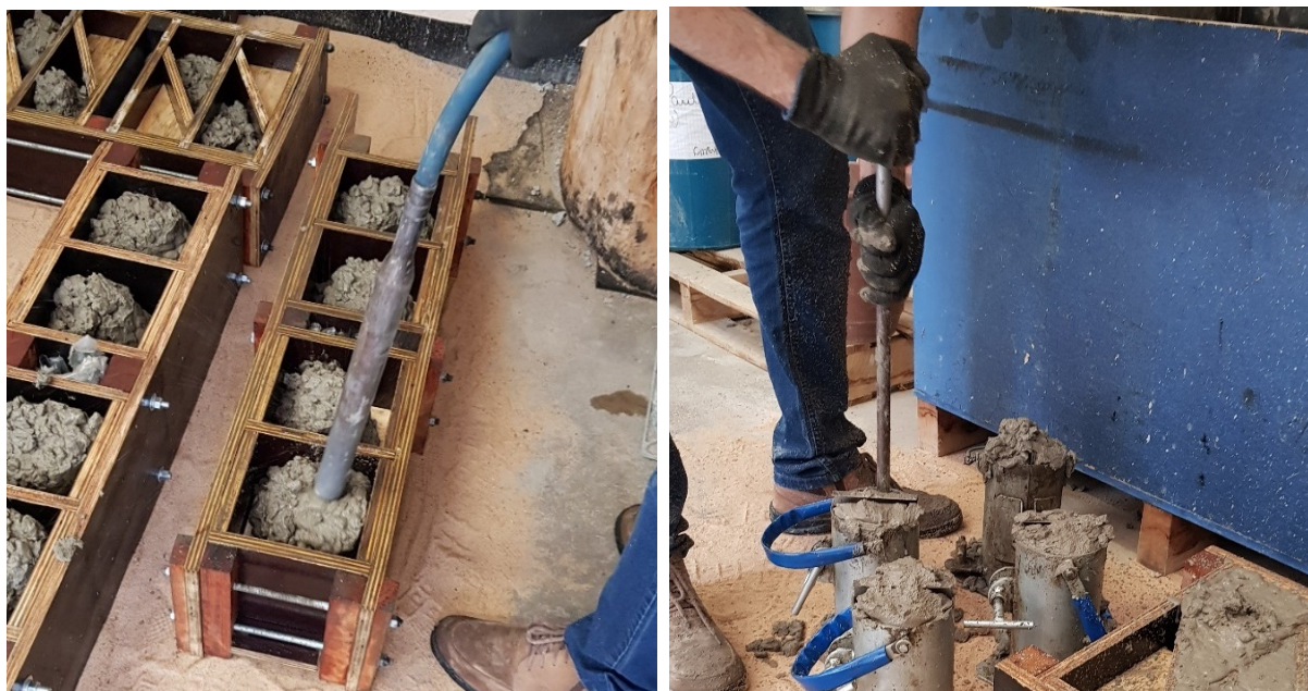
(a) Adensamento nas fôrmas de madeira com auxílio de vibrador
