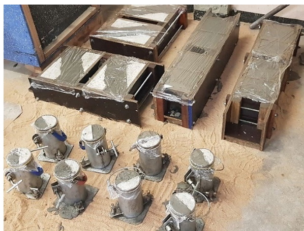
(b) Concretagem dos reparos (nesta foto, UHPC)
