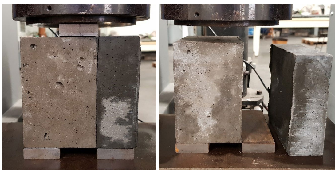
(c) Ruptura em modelo misto
