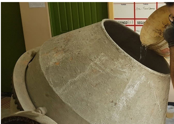
(c) Etapa 2: Mistura com água com duração de aproximadamente 2 minutos
