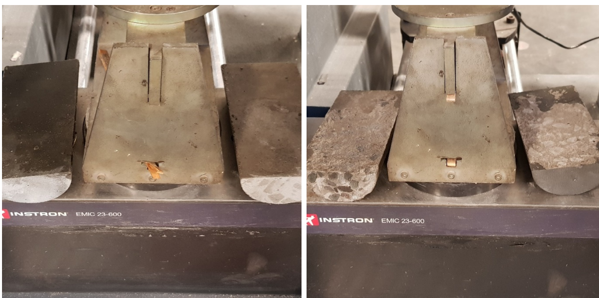
(c) Ruptura tipo em modelo misto
