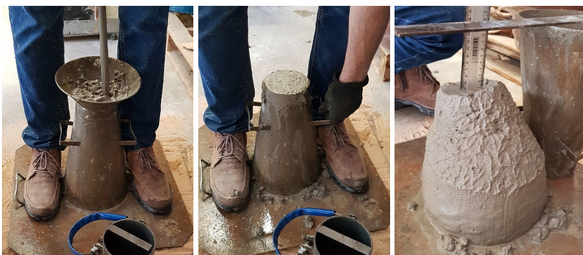
Figura 3.6 – Ensaio de abatimento do tronco de cone ( slump test ) dos concretos
