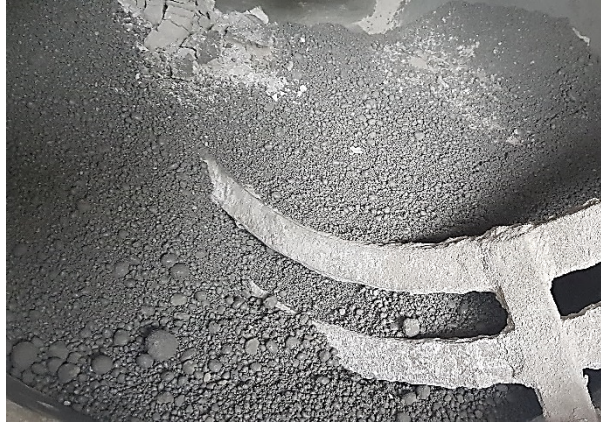
(f) Aspecto do UHPC após 20 minutos da mistura com superplastificante
