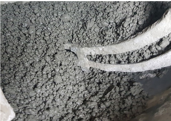
(g) Etapa 4: Mistura do UHPC até atingir a consistência desejada
