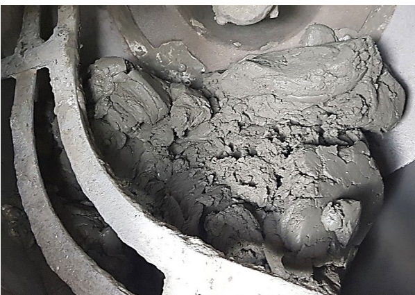
(i) Etapa 4: Evolução do aspecto do UHPC até atingir a consistência desejada
