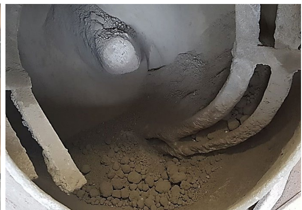
(d) Aspecto do UHPC após 10 minutos da mistura com água
