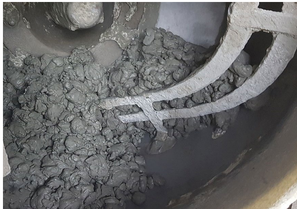
(h) Etapa 4: Evolução do aspecto do UHPC até atingir a consistência desejada
