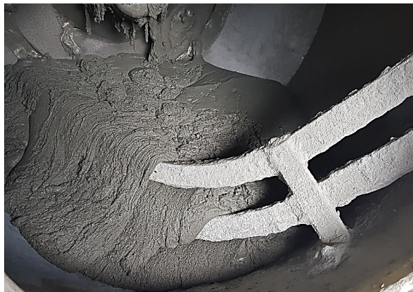
(j) Etapa 4: Consistência desejada do UHPC, após aproximadamente 5 minutos de mistura
