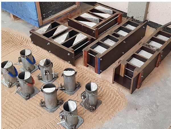
(a) Fôrmas com os corpos de prova parciais
