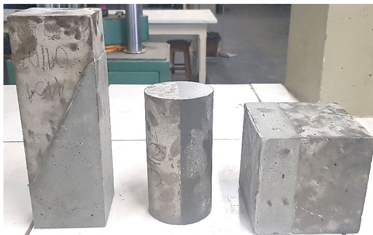
Figura 3.22 – Aspecto final dos corpos de prova dos modelos mistos com respectivos reparos
