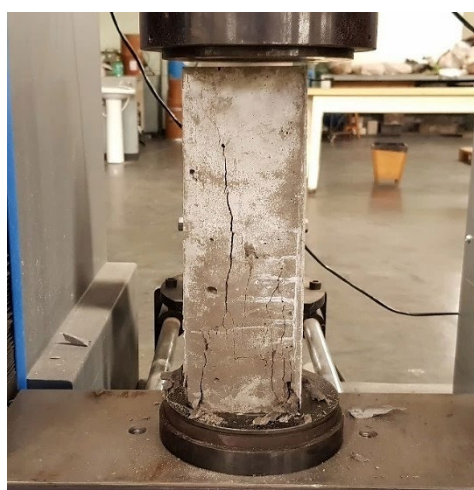
(b) Ruptura em modelo monolítico
