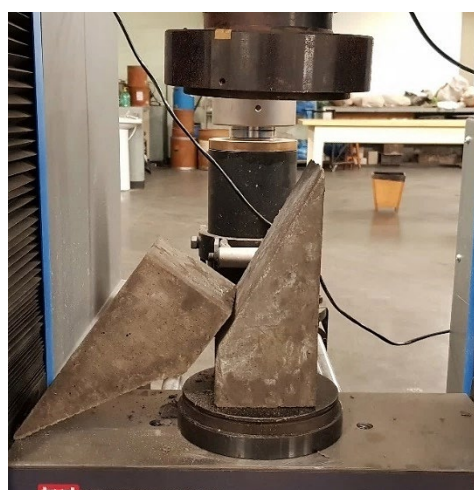
(d) Ruptura em modelo misto
