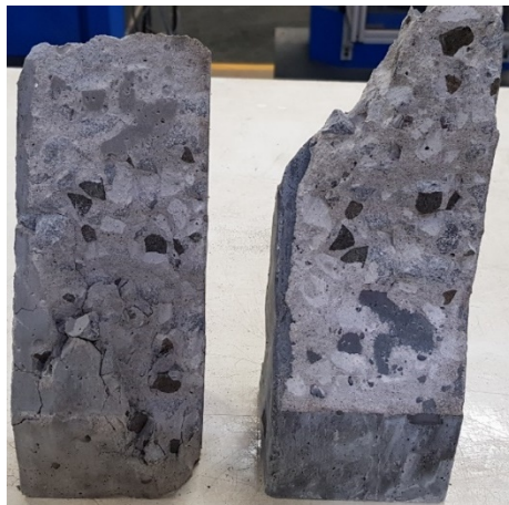
Figura 3.34 – Modo de ruptura C (falha coesiva)
