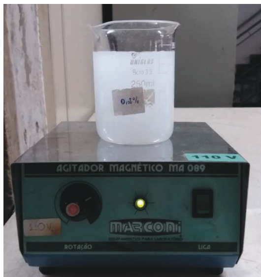
Figura 15. Agitação da microcelulose imersa em água. Fonte: O autor (2017).
