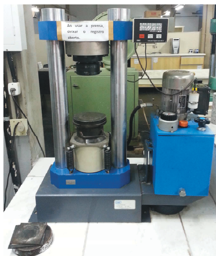
Figura 19. Equipamento para ensaio de resistência a compressão e tração na flexão. Fonte: O autor (2017).
