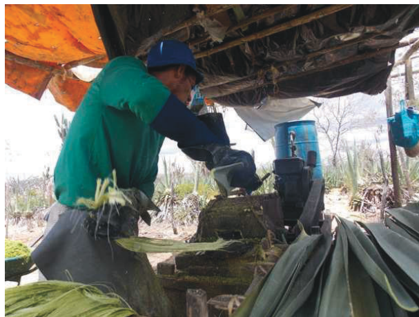
Figura 4. Desfibramento do sisal
