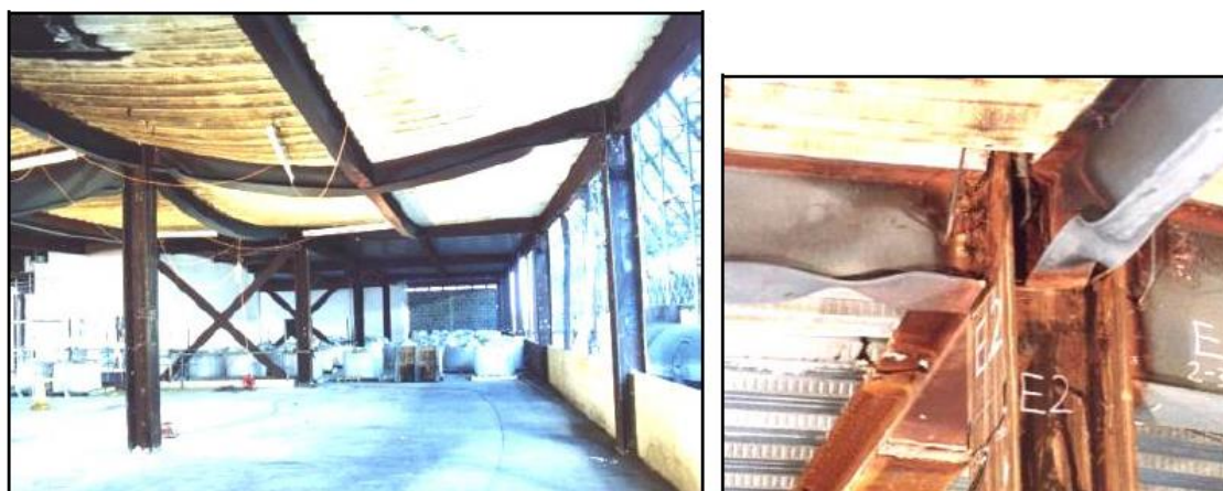
Figura 2 – Vista de um dos pavimentos em sua configuração deformada após os ensaios
