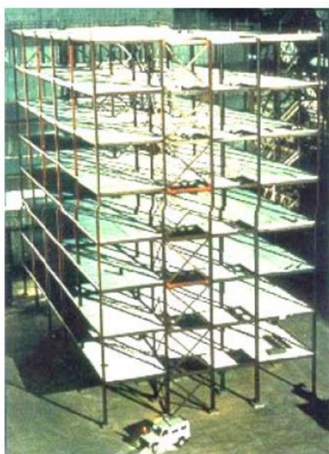
Figura 1 – Ensaio em escala real conduzido em um edifício de 8 (oito) pavimentos
