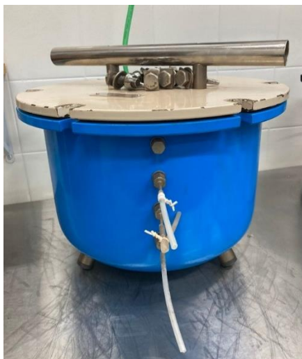
Figura 3.12 – Câmara de pressão de Richards
