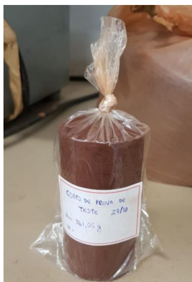
Figura 3.13 - Corpo de prova moldado para os ensaios de compressão triaxial
