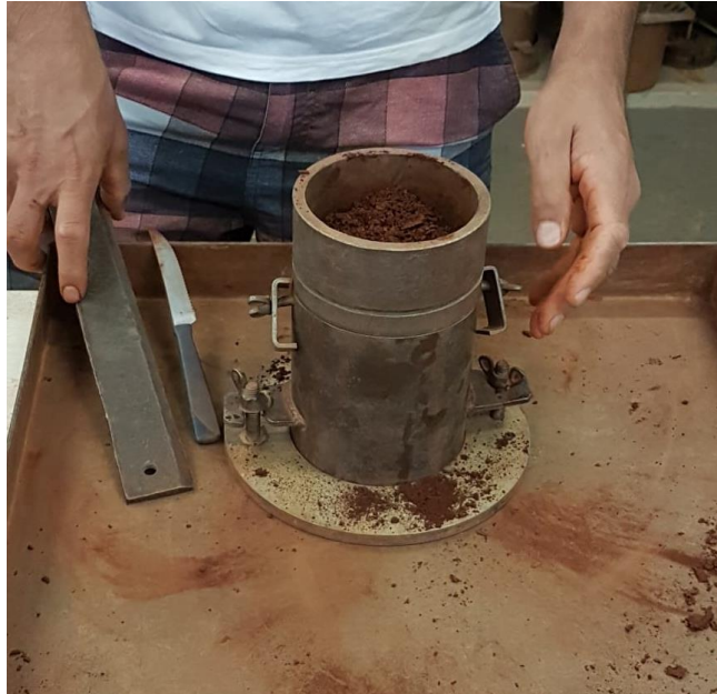
Figura 3.10 - Cilindro pequeno utilizado no ensaio de compactação
