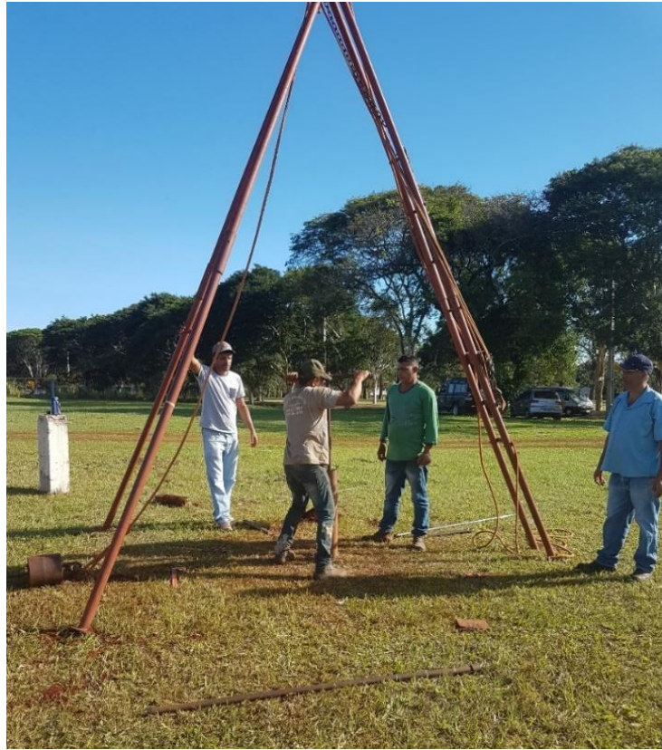
Figura 3.3 – Ensaio de sondagem de simples reconhecimento SPT – Campo experimental UEM
