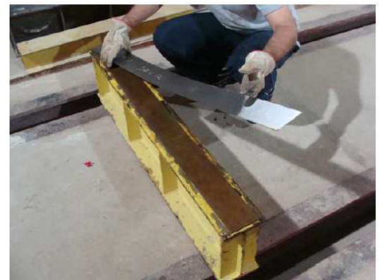
Figura 3.2: Preparação do apoio para as lajes. a: aplicação da graxa na chapa inferior. b: posicionamento da chapa superior.
