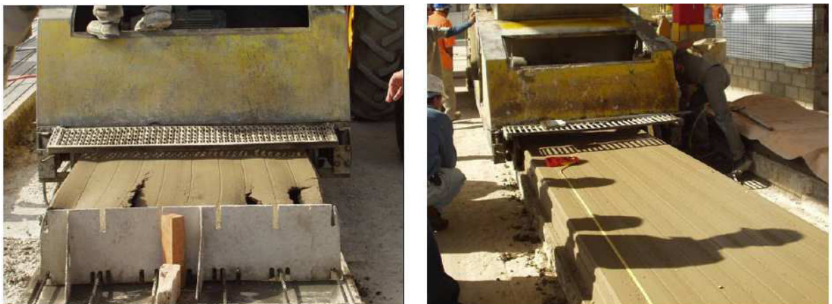
Figura 2.9: Moldagem das unidades alveolares
