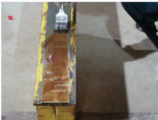
Figura 3.2: Preparação do apoio para as lajes. a: aplicação da graxa na chapa inferior. b: posicionamento da chapa superior.
