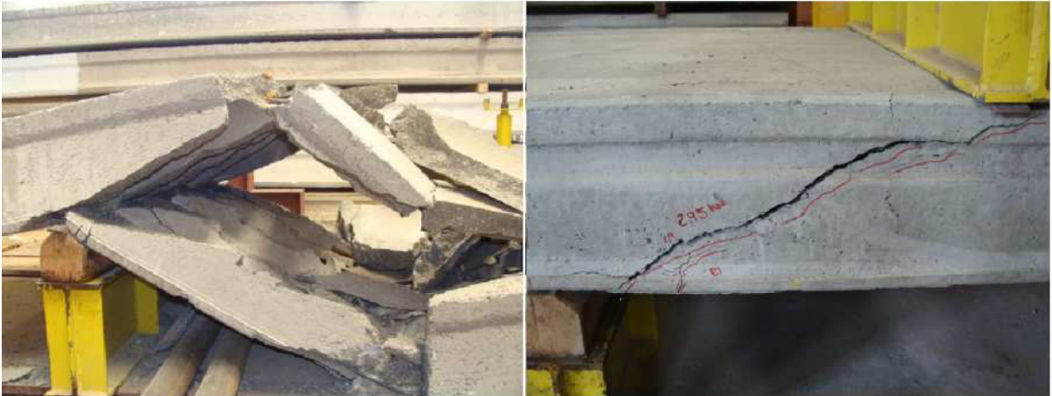
Figura 2.16: Rupturas por tração diagonal em lajes alveolares
