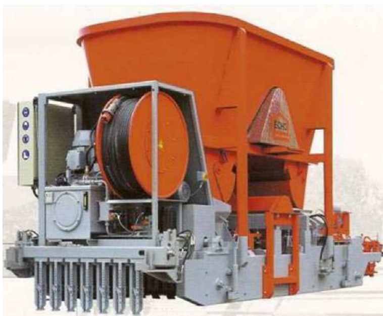
Figura 2.6: Máquina utilizada no processo de fabricação pelo método da forma deslizante
