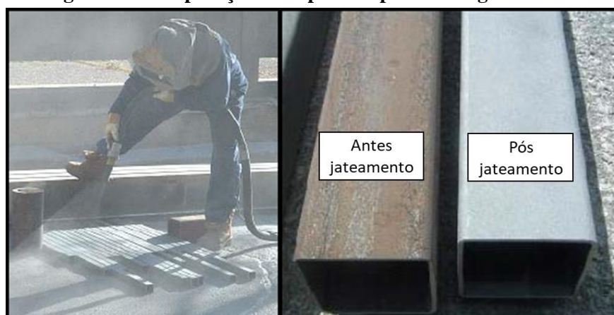
Figura 5.4 - Preparação da superfície para a colagem do PRF
