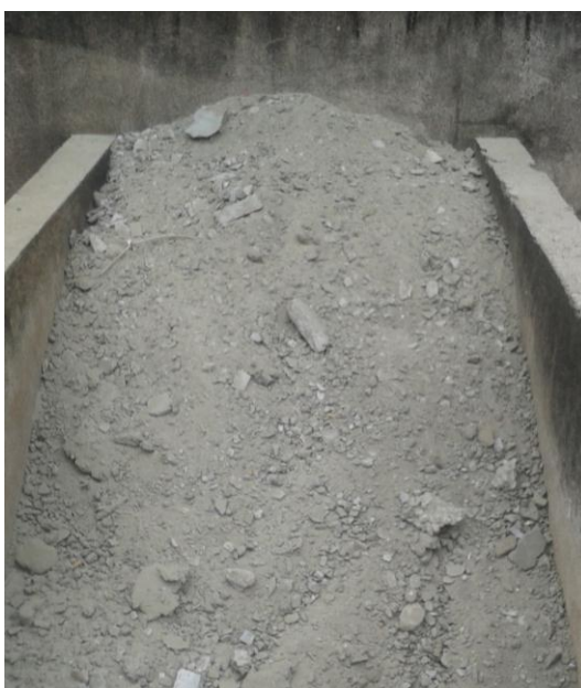
Figura 4.1 – Resíduo de concreto no estado natural
