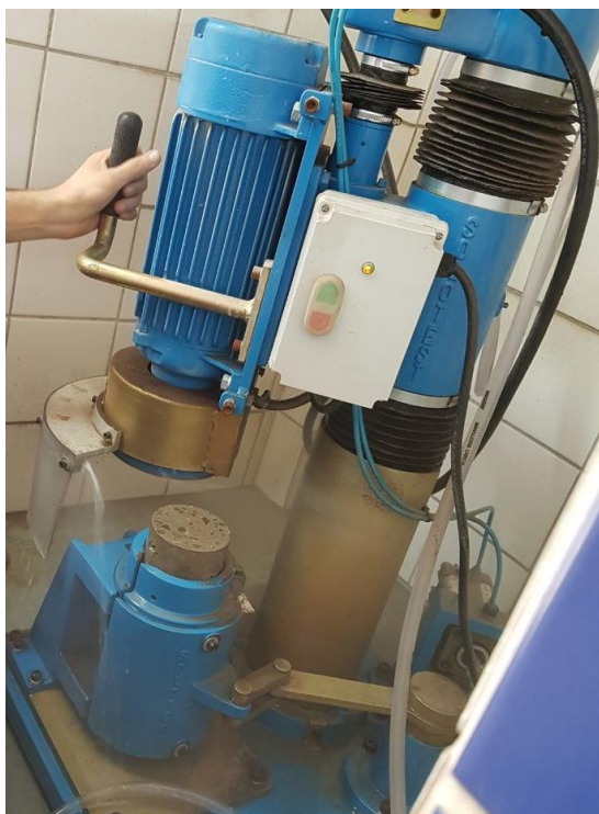
Figura 5.7 – Retífica utilizada para regularização da superfície dos corpos de prova
