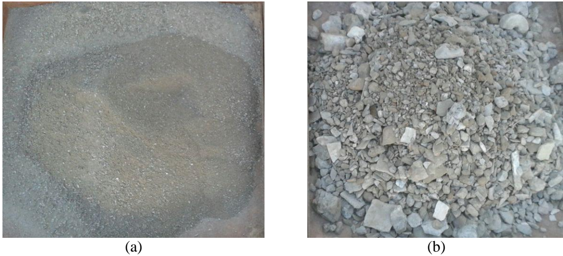
Figura 4.2 - Separação do resíduo em frações: (a) fração miúda, passante na peneira #4,8 mm, e (b) fração graúda, retida na peneira #4,8 mm.
