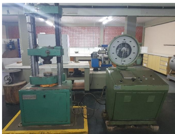
Figura 5.8 – Máquina Universal de Ensaio EMIC MUE 100.
