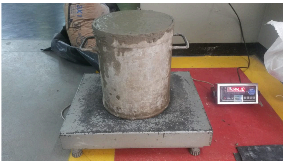
Figura 5.8 – Determinação da massa específica do concreto no estado fresco
