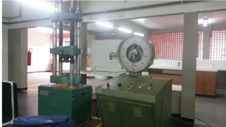
Figura 5.9 – Prensa hidráulica de 100 toneladas
