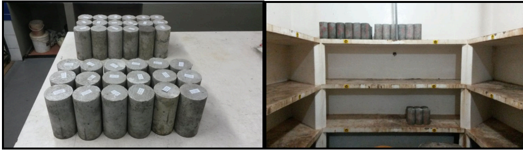
(a) corpos de prova desmoldados
