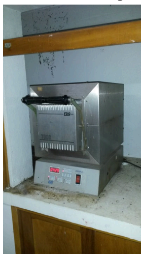
Figura 5.13 – Forno mufla operado a 900°C
