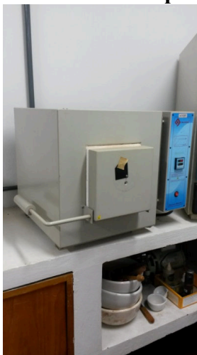
Figura 5.12 – Forno mufla operado a 600°C
