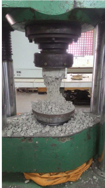
Figura 6.16 – Desintegração de concreto referência após ensaio
