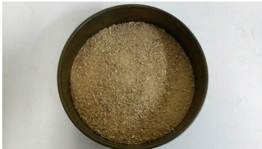
Figura 6.4 – Resultado final do agregado miúdo reciclado triturado
