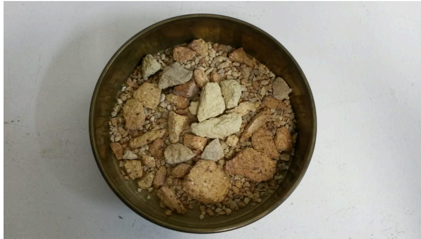
Figura 6.3 – Resultado dos tijolos refratários após trituração
