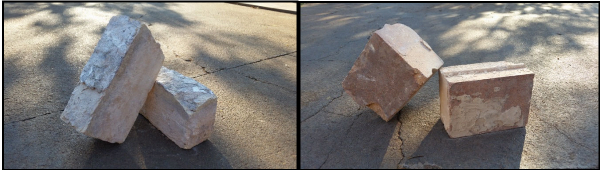
(a) Tijolo refratário de fornos de cal
