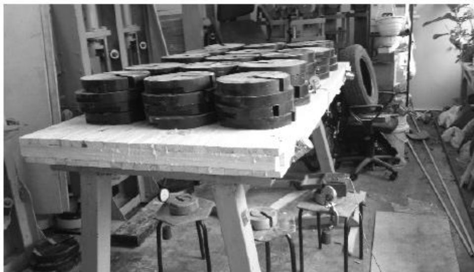
Figura 2.44 – Representação esquemática do aparato de ensaio de painéis de MLCC empregado por Vilguts, Serdjuks e Pakrastins (2015)
