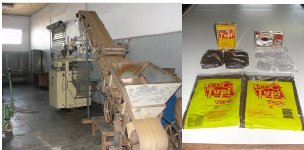
Figuras 29 e 30: Maquinário utilizado para embalar o chá preto Fotos: Alessandro Aoki, 2010
