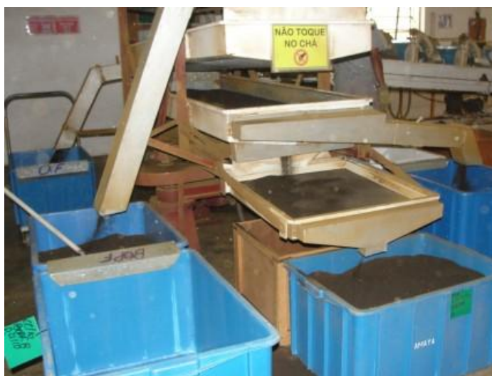
Figura 27: Processo de separação granulométrica do chá Foto: Alessandro Aoki, 2010
