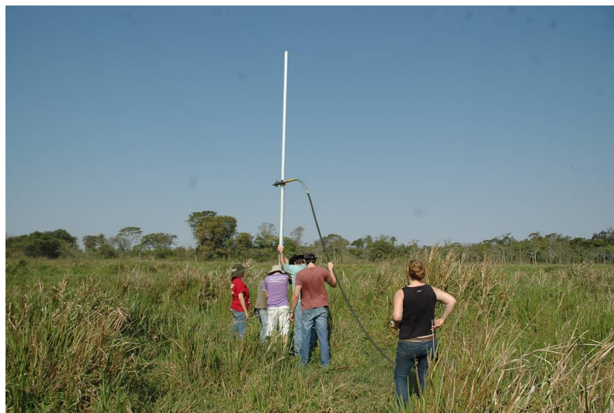
Figura 25: Sondagem com vibrocore para retirada de amostras de solo e matéria orgânica em áreas com turfas.
