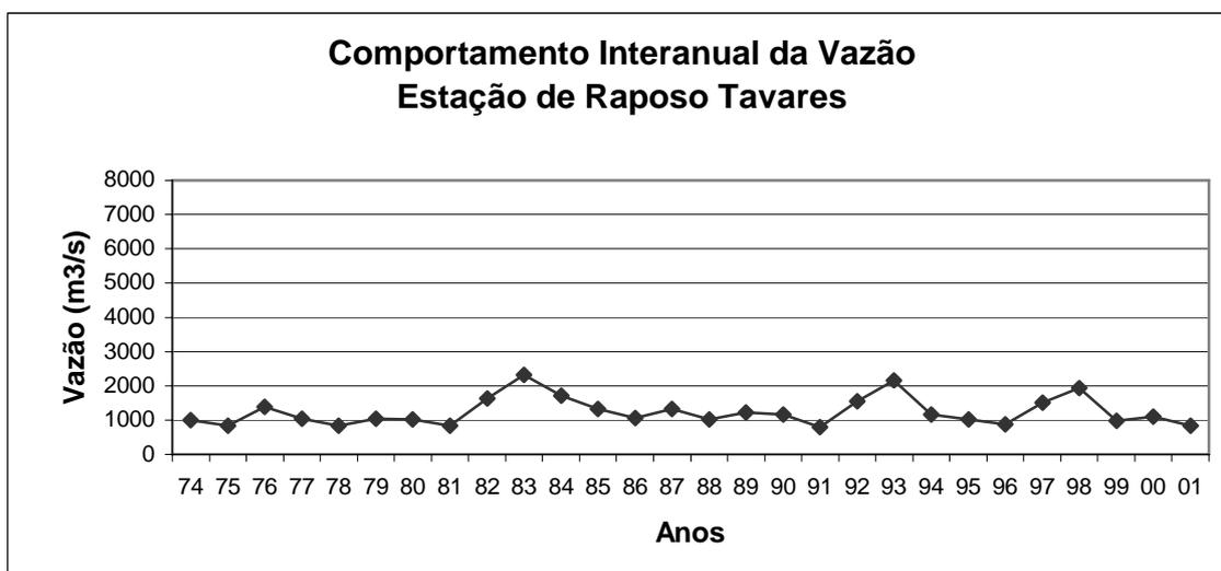
Figura 76 – Evolução interanual da vazão da estação Raposo Tavares – 1974 a 2001
