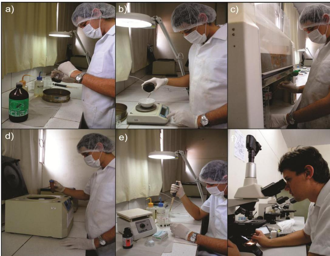
Figura 16: Fotografias mostrando as diferentes etapas necessárias para a extração dos fitólitos. a) peneiramento da amostra b) preparação para queima de matéria orgânica c) inserção de ácido clorídrico (HCL) nas amostras d) centrifugação das amostras e) preparação de lâminas de microscopia f) análise das lâminas em microscópio óptico
