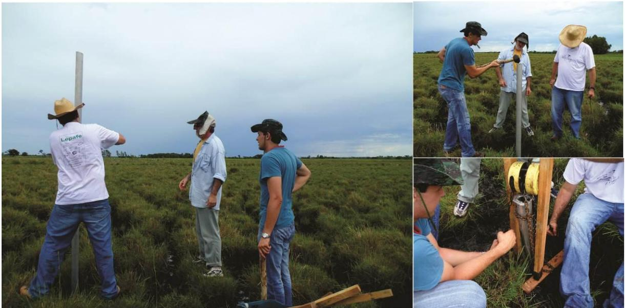
Figura 14: Fotografias exibindo etapas do trabalho de campo onde se realizou a sondagem no terraço Ivaí para a retirada de testemunho de amostra.
