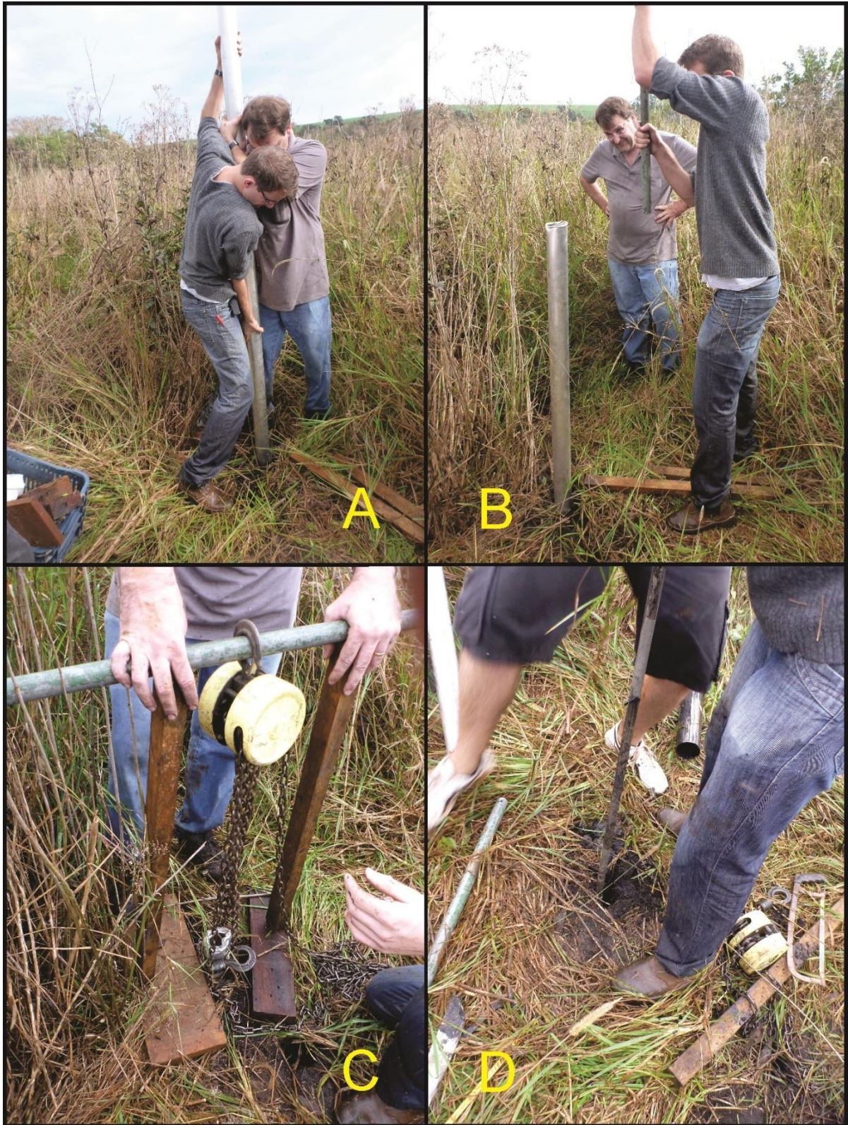
Figura 22: Sondagem na planície do rio Ranchinho com o uso da marreta e tradagens superficiais. Fonte: Acervo do autor, junho 2013.
