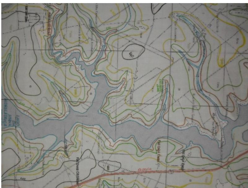
Figura 36: Destaque para o lago e as curvas de nível em cores diferentes.
