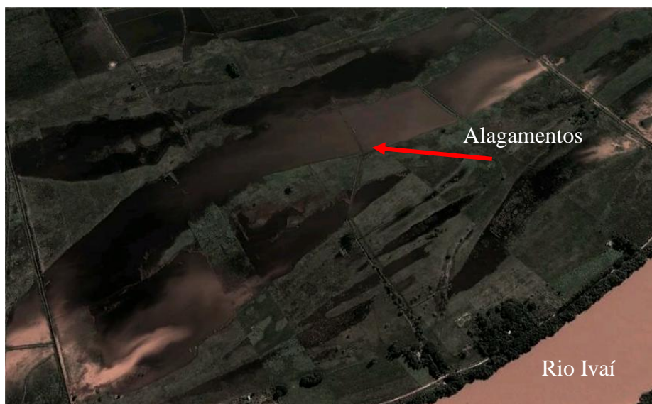
Figura 43: Área alagada por acumulação de água decorrente de precipitações locais intensas e por contribuição do lençol freático. Fonte: Google earth.
