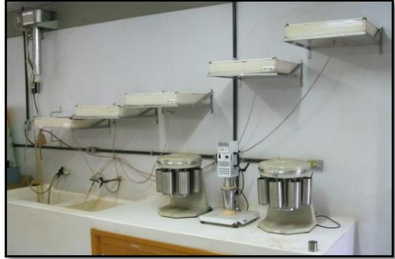
Figura 6: Detalhe da disposição das Mesas de tensão, com colunas de água de 50 a 100 cm.
