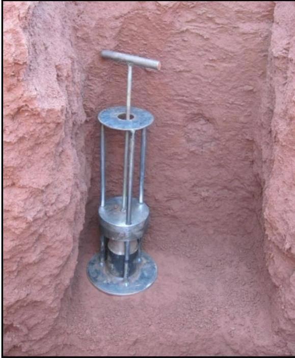
Figura 3: Equipamento utilizado para a coleta das amostras de solos em anéis volumétricos.
