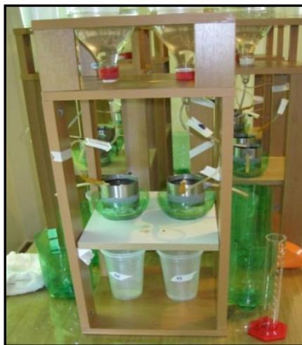
Figura 7: Equipamento utilizado para medir a condutividade hidráulica.
