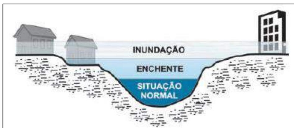
**Figura 22 - Perfil esquemático de eventos de enchente e inundação.**
