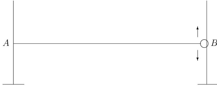
Figura 1: Corda de violão tensionada. Na extremidade  $A$  a corda está presa enquanto na extremidade  $B$  a corda pode se movimentar para cima e para baixo.
