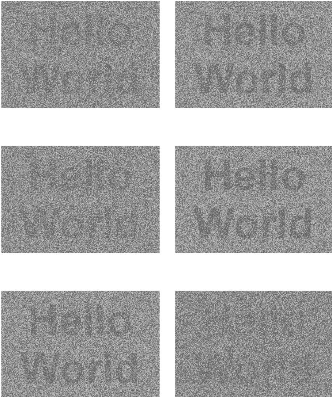
Figura 4.15: Simulações com probabilidade de erro  $p = 0.4$  usando os codificadores de canal  $f_h$  (acima),  $f_b$  (no centro) e  $f_{\tilde{b}}$  (embaixo): à esquerda imagens decodificadas com  $a_H$ ; à direita imagens decodificadas com  $a_P$ .
