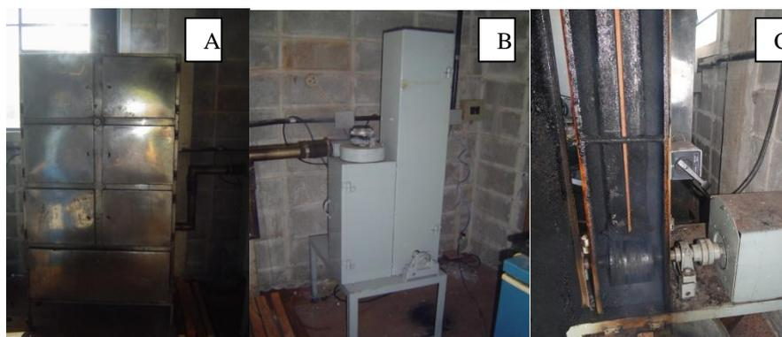
Figura 3 – Defumação a quente. A) Defumador inox; B) Gerador de fumaça por fricção; C) Parte interna do gerador de fumaça
