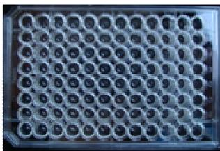
**Figura 2.** Placa de acrílico composta de covas com capacidade volumétrica de 4 ml, adaptada para estocar embriões de peixes durante a fase de desenvolvimento embrionário
